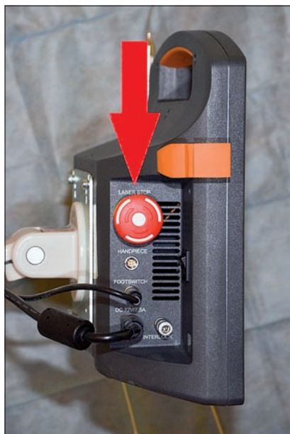
Ryc. 5. Przycisk STOP do awaryjnego przerywania pracy urządzenia (rzut z góry na obudowę urządzenia, strzałką oznaczono przycisk STOP).
