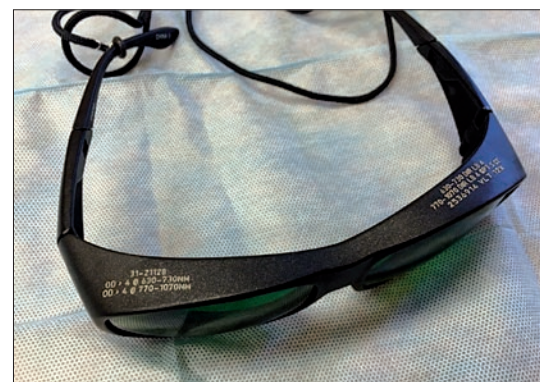
Ryc. 2. Okulary ochronne z oznaczeniami filtrów dla długości fali promieniowania.
